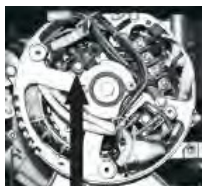
Figura D - Posizione delle spazzole di carbone. Alla fine, questo elemento potrebbe dover essere sostituito quando si usura.
