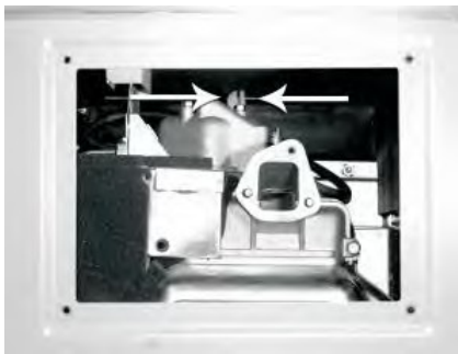
Figura A - Rimuovere il pannello laterale, quindi rimuovere il filtro d'aria. Individuare la leva di decompressione "rossa" (la foto sopra la mostra in posizione UP). Premere la leva verso il basso per tenere aperta la valvola di scarico. Sostituire il gruppo del filtro d'aria. Avviare il motore. Si noter  che la leva a molla torner  automaticamente in posizione UP (indicata anche come gruppo dell'albero di decompressione sullo schema dei componenti).
