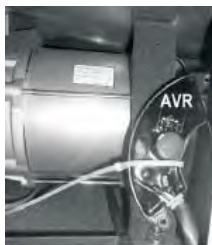
Figura B - Posizione del regolatore automatico di tensione (AVR). Alla fine, questo elemento potrebbe dover essere sostituito quando si usura.
