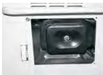
Figura 9 - Schimbarea filtrului de aer
