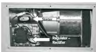
Figura C - Locația panoului de acces din spate care a fost eliminat. Puteți vedea locația demarorului și regulatorului / punții redresoare pentru bateria de pornire de 12V. Demarorul este situat deasupra regulatorului / punții redresoare.
